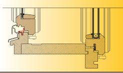
Leistenpfostenstock: Außenflügel (Floatglas) nach außen Innenflügel (Floatglas) nach innen
