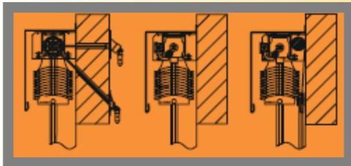
Raffstore-Behänge in der konventionellen Bauart mit der Kopfleiste oberhalb des Lamellenstapels.
